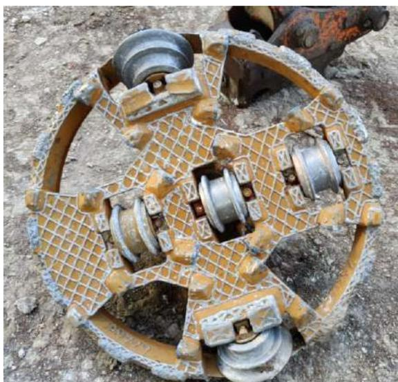
Figura 13. a) Testa fresante a fine perforazione
