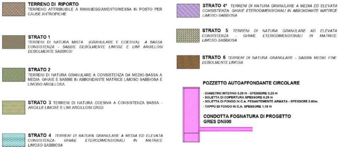
Figura 4. Legenda sezione geotecnica interpretativa sottoattraversamento alveo fiume Sile
